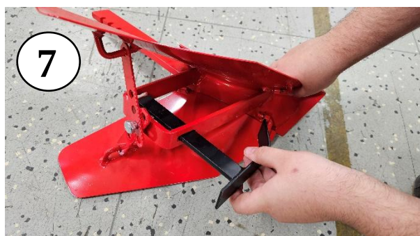
Obr.7 – nastavitelný plaz je zasunut dle požadované hloubky brázdy.
