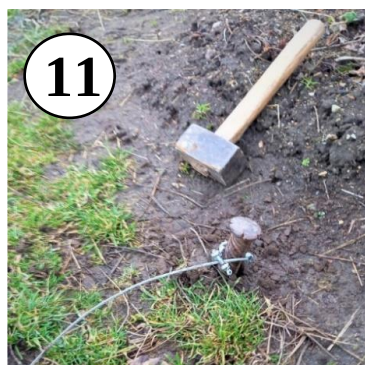
Obr.11- lanko navijáku musíme zajistit o pevný bod, například strom. Případně použít pevnou tyč, trubku, roxor a pomocí palice zatlouci hluboko do země
